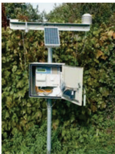
Fig. 3 : Contrairement aux stations météorologiques actuelles, qui transmettent leurs données en temps réel via le réseau de téléphonie mobile, les premières stations fournissaient des données uniquement sur papier. Un thermo-hydrographe de l'entreprise Lufft a été utilisé pour la mesure de l'humidité du feuillage. Photos : Gottfried Bleyer, WBI Freiburg.
