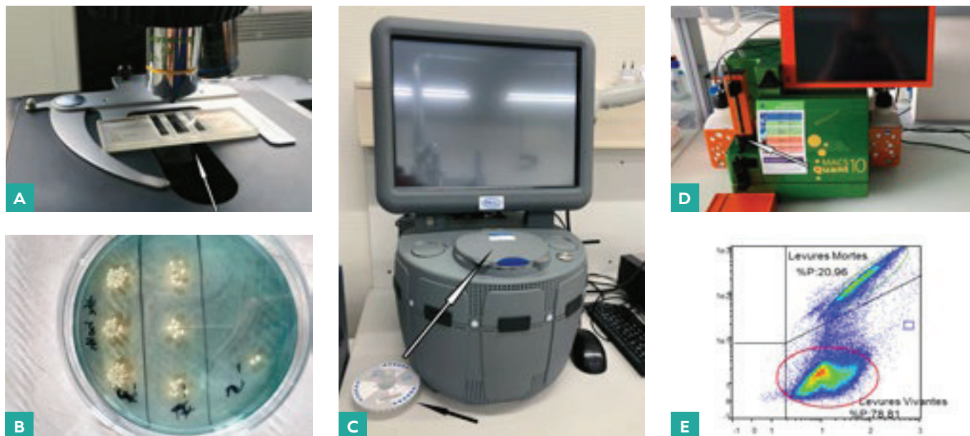
Fig.1 Les trois catégories d'outils de la microbiologie. A. Comptage direct des micro-organismes. Une aliquote de l'échantillon est chargée dans la chambre de comptage (flèche blanche) et les microorganismes sont dénombrés par observation au microscope. B. Colonies de levures en croissance sur milieu gélatineux dans boîte de Petri. C. Le système PCR Genedisc de Pall, utilisé par l'école HES-SO de Changins. Les échantillons d'ADN sont chargés dans les micro-puits du disque (flèche noir). Une fois insérée dans le système (flèche blanche), la réaction PCR aura lieu dans les puits et le résultat s'affiche à l'écran. D. L'analyseur de cytométrie en flux MACSQuant de Miltenyi Biotech, utilisé par Agroscope. Un petit volume (20–100 microlitres) de l'échantillon contenant les micro-organismes est automatiquement prélevé d'une aiguille (flèche blanche) et analysé. E. Graphique « Dot plot » illustrant les résultats d'une analyse de cytométrie en flux. Chaque cellule est représentée par un point (carré bleu). Des groupes de cellules qui possèdent les mêmes caractéristiques de fluorescence émise par des réactifs particuliers sont regroupés en groupes. Le graphique montre les populations de cellules vivantes (entourées en rouge) et mortes (entourées en vert) et leur pourcentage par rapport au nombre total de cellules.
