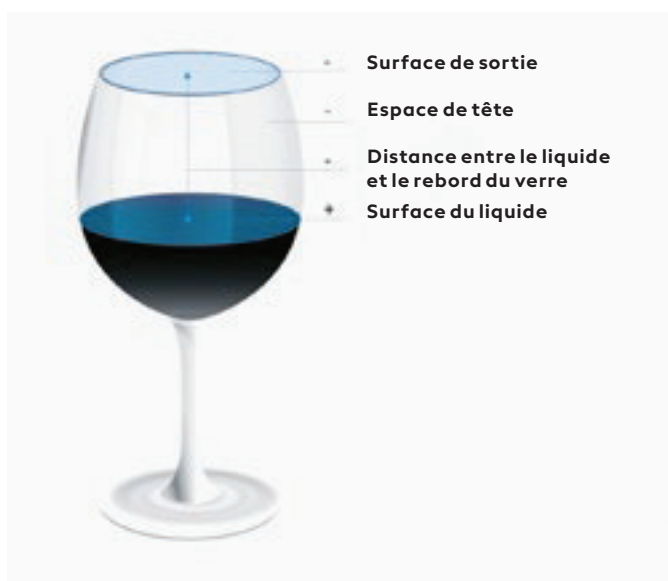
Fig. 3 : La forme et la fonction d'un verre à vin sont essentiellement déterminées par quatre paramètres. +/- = corrélation hypothétique avec la concentration des arômes dans le verre. (© Agroscope)
