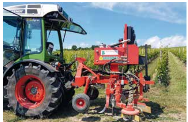
Figure 2 | Entretien du sol avec un outil intercepts rotatif (photo F. Hugon, Agrigenève).
