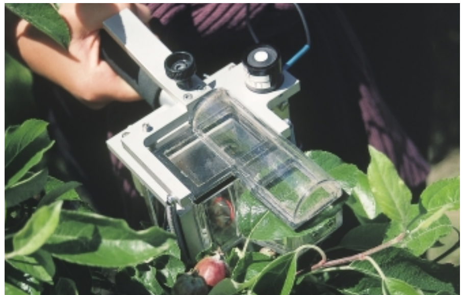
Fig. 5. Chambre d'assimilation de l'appareil de mesure de photosynthèse LiCor 6200 dans laquelle est insérée une feuille de pommier.
