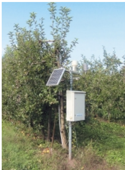
Fig. 1. Exemple de stations de mesures en arboriculture de La Tour-de-Peilz et de Saxon. Les paramètres requis pour la prévision sont mesurés par des stations Campbell CRX ou Lufft HP-100 placées dans les vergers.
