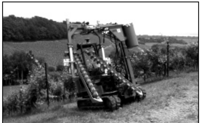
Tracteur Viti-plus équipé d'une palisseuse Ero
