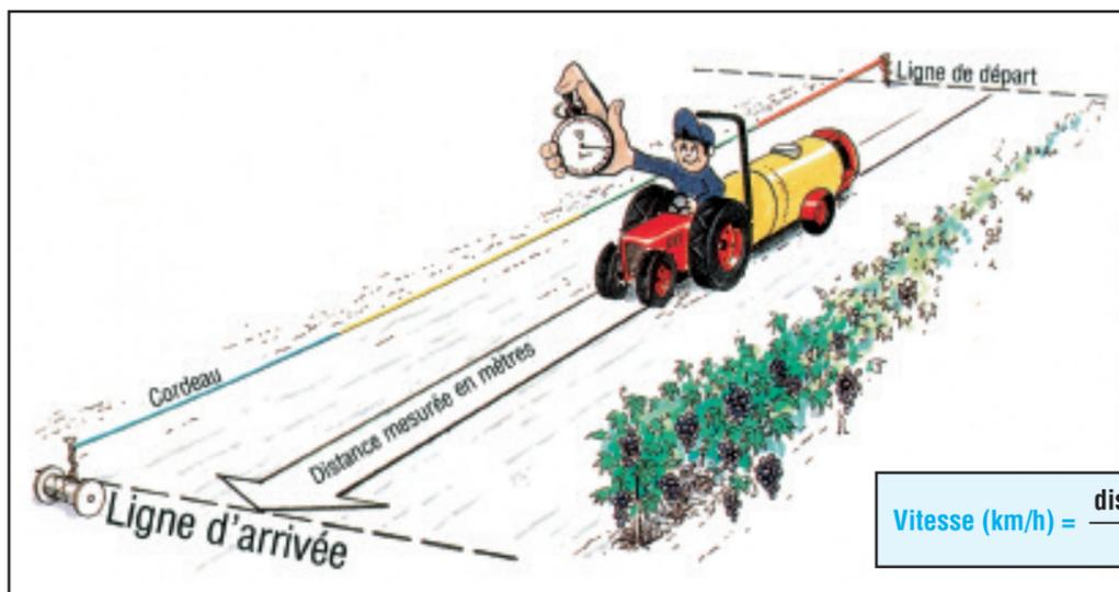
Parcourir une distance de 100 m au rapport de vitesse et au nombre de tours/minute du moteur utilisés pour la pulvérisation, en mesurant le temps nécessaire en secondes.
