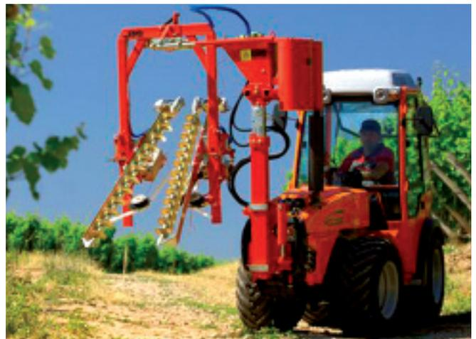
Tracteur équipé de la machine à palisser ERO
