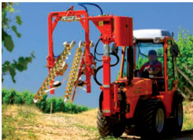
Tracteur équipé de la machine à palisser ERO
