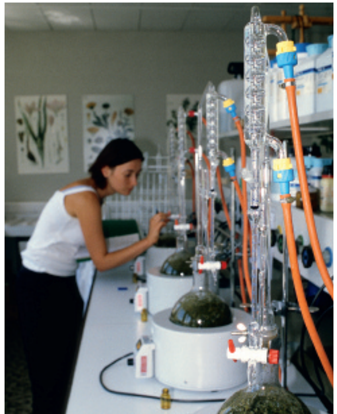
Mesure de la teneur en huile essentielle par hydrodistillation dans les laboratoires de Médiplant.
