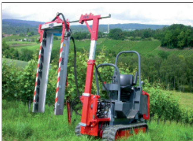
Tracteur Viti-star équipé de la Cisailleuse ERO
