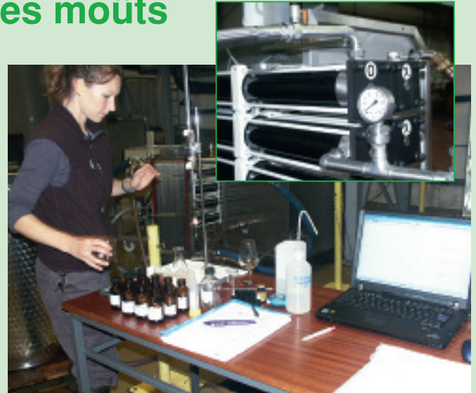
Essai de démalication lors des vendanges 2006. Détail: osmoseur et membranes de nanofiltration.
