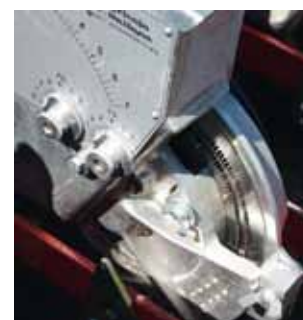
Figure 6 | Gros plan d'un élément du semoir : les semences sont aspirées contre le disque et distribuées avec une excellente régularité dans le sol. (Photo F. Fournier, Valplantes)
