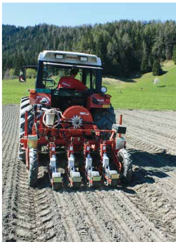
Figure 5 | Semis de thym vulgaire à Bruson au semoir de précision pneumatique. (Photo F. Fournier, Valplantes)
