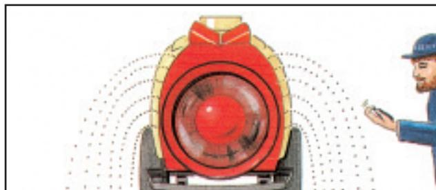
3 A l'aide d'un seau gradué, déterminer la quantité d'eau écoulee durant les 2 minutes en remplissant à nouveau la cuve au niveau initial.
