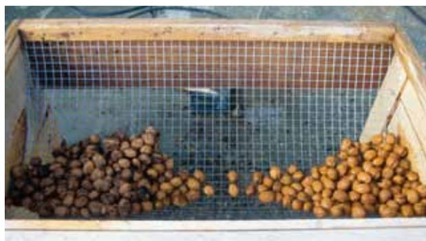
Figure 5 | Installation «maison» de nettoyage et de filtration des coques. (Photo T. Schwizer, ACW.)
