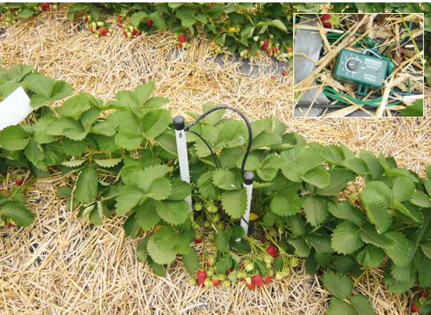
Figure 1 | Gestion automatisée de l'irrigation basée sur des sondes Watermark® et pilotée par le système WEM (Watermark Electronic Module).
