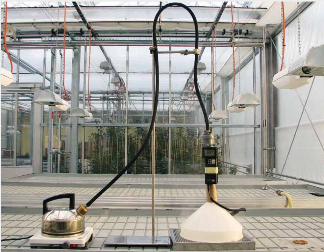
Figure 2 | Installation de désinfection des semences à la vapeur aérée: source de vapeur, tuyau souple, système d'injection avec réglage de la température et cloche pour le traitement. A droite, semence étalée sur un treillis avant le traitement. Lorsque le système a atteint la température désirée, le treillis portant les semences est mis sous la cloche. La vapeur s'échappe sans encombre par la grille au-dessous du treillis.
