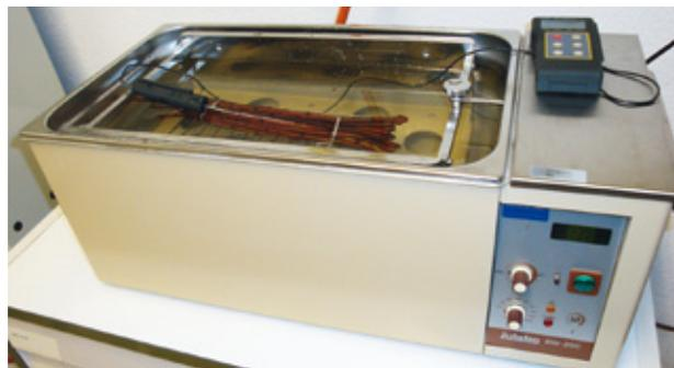
Figure 2 | Fagot de greffons attaché à la structure permettant d'agiter le bain d'eau à 50 °C.
