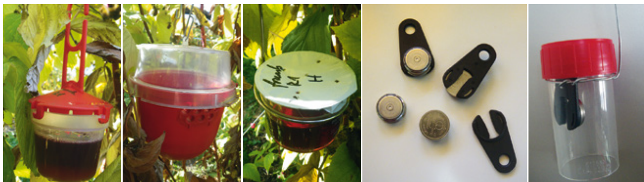
Figure 1 | Pièges et sondes du monitoring, de gauche à droite: piège Profatec, Biobest Droso trap, Riga Becherfalle, sondes de température et humidité (iButton) avec supports, sonde dans une éprouvette sans fond prête pour utilisation.
