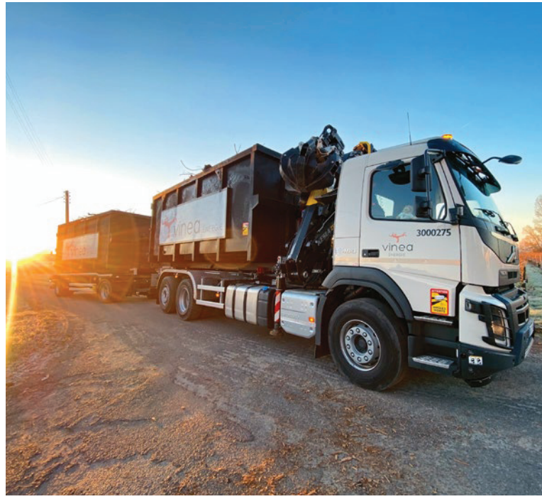
Camion grappin double benne. Photo : Vinea Énergie.
