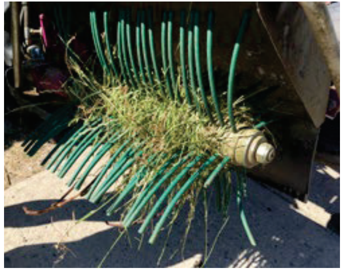
Les outils de désherbage mécanique qui longent le cep sont rapides et efficaces, à l'image des outils rotatifs à fil à axe horizontal. Photo : David Marchand.
