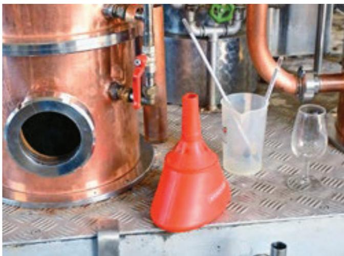
**Les outils du distillateur « à façon » : un alambic, des entonnoirs, des thermomètres à alcool et un verre s'assurer de la qualité du distillat.**
