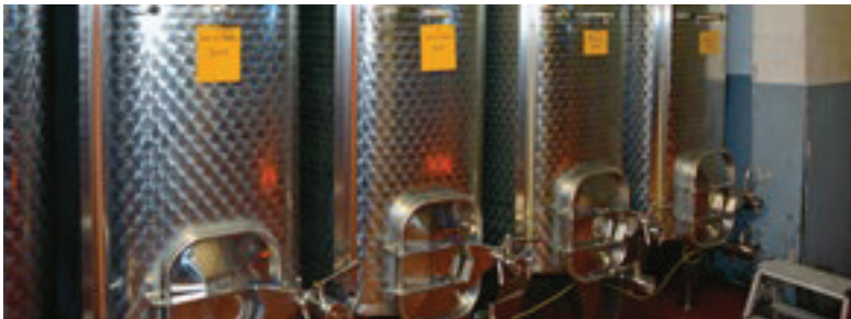
Captage de CO 2 à la source. Le gaz produit est directement évacué à l'extérieur du bâtiment.
