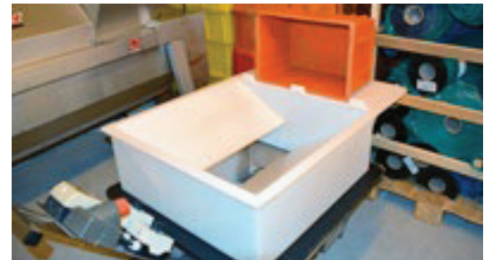
Décuveur équipé de réhausse avec chicanes.
