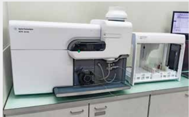
Le système d'analyse MP-AES de la société Agilent est capable de fournir des analyses multi-élémentaires. Photo: A. Pernet, Changins.
