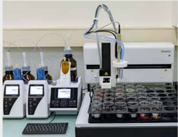
Grâce au quatre burettes et au passeur, le titreur automatique de SI Analytics permet de mesurer le pH, l'acidité titrable, le SO 2 libre et total sur 44 échantillons sans nécessité d'intervention.
