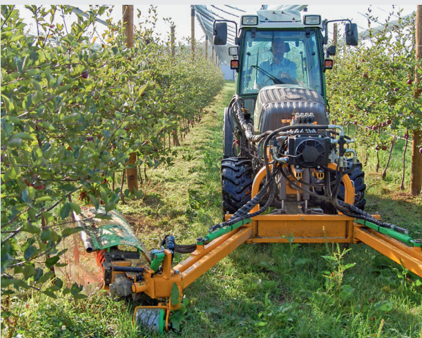
Figure 5 | Désherbage avec un outil rotatif à fils. Verger de Reynald Pasche, Prangins (VD).
