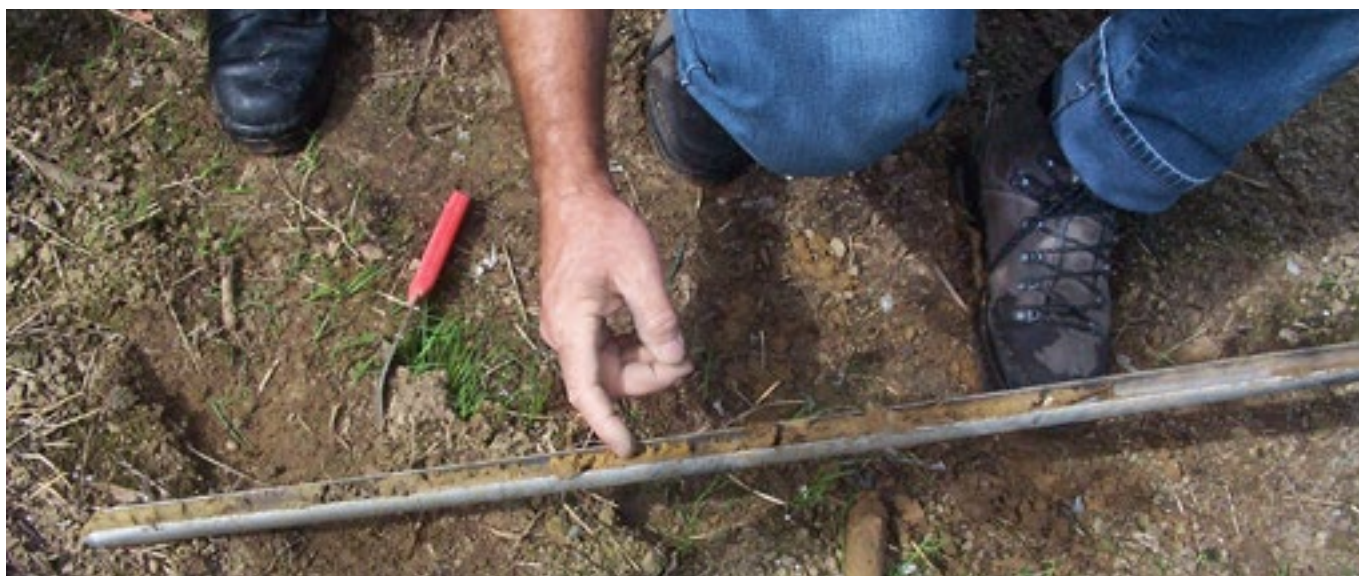
Carottage d'un sol qui permet d'estimer la matière organique (et donc le carbone) présent. Photo : Agroscope.
