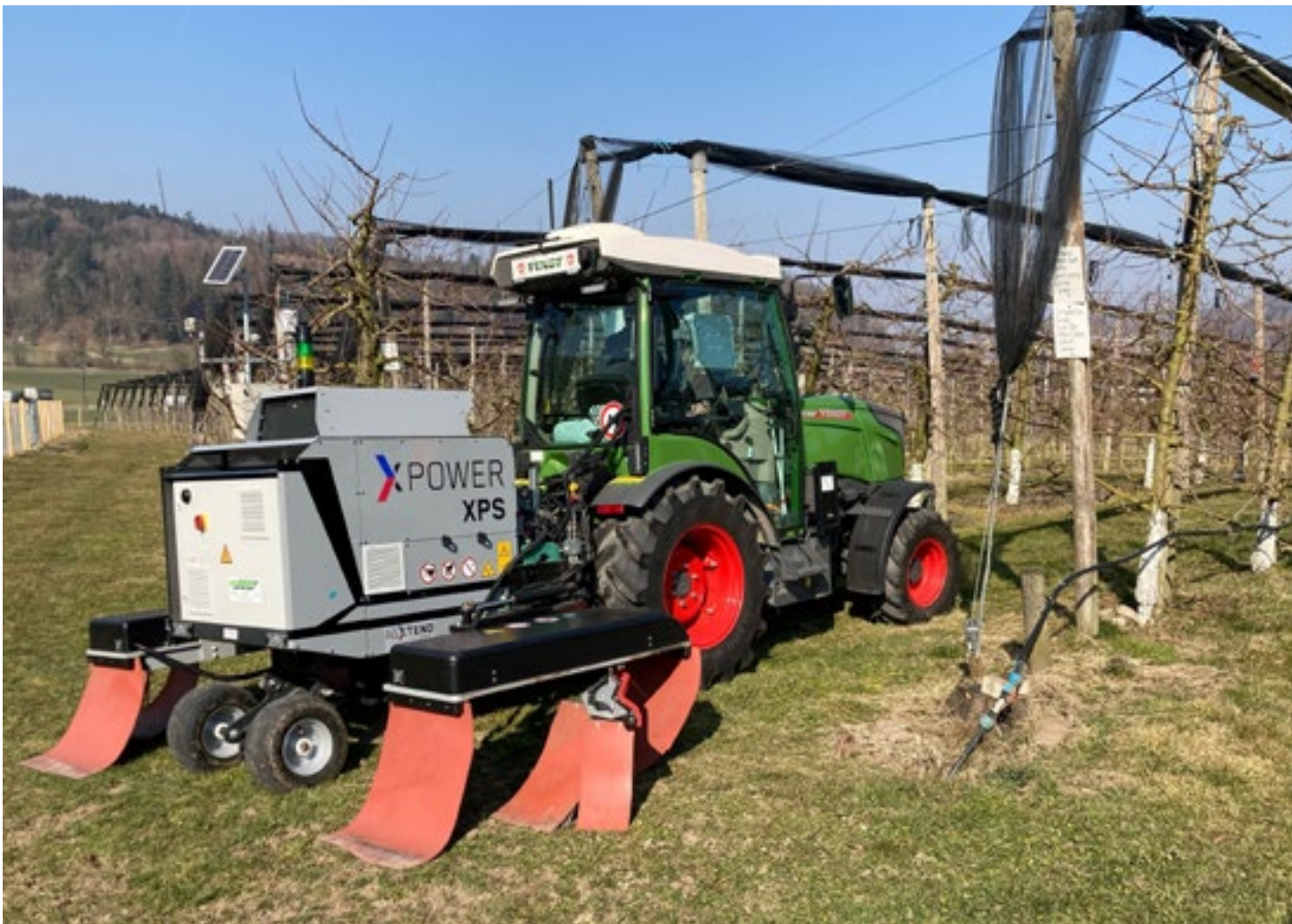
Photo 1: Machine pour le désherbage électrique Xpower. Photo: AGROLINE.
