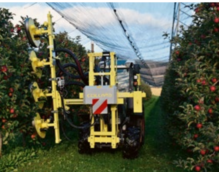
Figure 6 : Effeilleuse de la société Collard utilisée sur des pommiers Rosy Glow/ Pink Lady® (10 e année de plantation).
