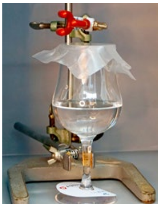
Fig. 2: Montage pour les mesures chromatographiques en phase gazeuse. Photo: SZOW.
