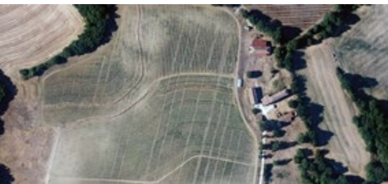
Fig. 2 : Vue aérienne des noues tracées sur une parcelle de 10 ha à Lectoure dans le Gers – Domaine d’Arton : les objectifs sont : i) les futurs aménagements paysagers et ii) une production fruitière. Les keylines vont être tracées et la vigne sera plantée en suivant les courbes de niveau au mois d’avril 2022 (Design, création, étude et conception A. Malard 2021 – Prise de vue vidéo par drone).
