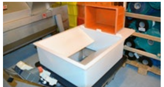
Dècuveur équipé de réhausse avec chicanes.
