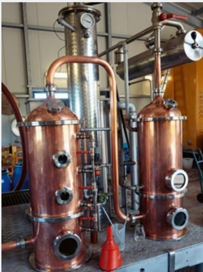
Les magnifiques colonnes de distillation en cuivre.
