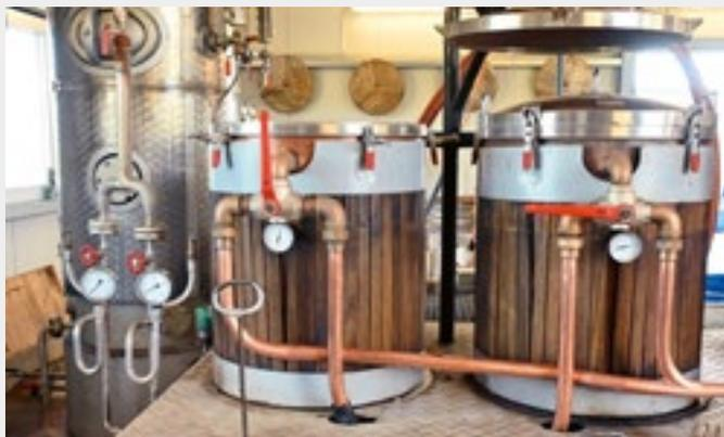
**Les deux « marmites » où le moût est chauffé pour faire évaporer le liquide qui passe dans les tuyaux de cuivre au premier plan. À l'arrière-plan, la chaudière à vapeur qui va chauffer les marmites. Au fond, accrochés au mur, les « paniers » qui permettent de récupérer les marcs solides au fond des marmites qui ne peuvent être évacués par le bas.**
