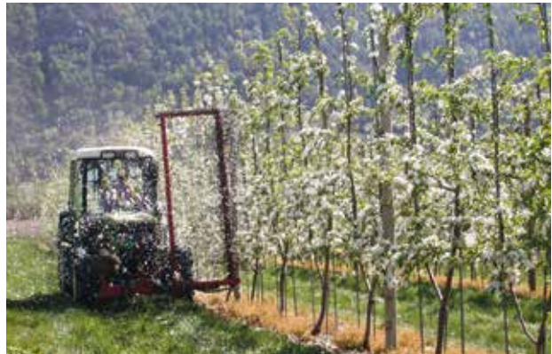
Figure 3 | Passage de la Darwin dans le MF à une vitesse d'avancement de 9,2 km/h et à une vitesse de rotation de 300 t/min.
