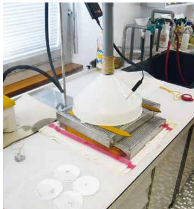
Figure 2 | Installation de laboratoire pour la désinfection des semences à la vapeur aérée.
