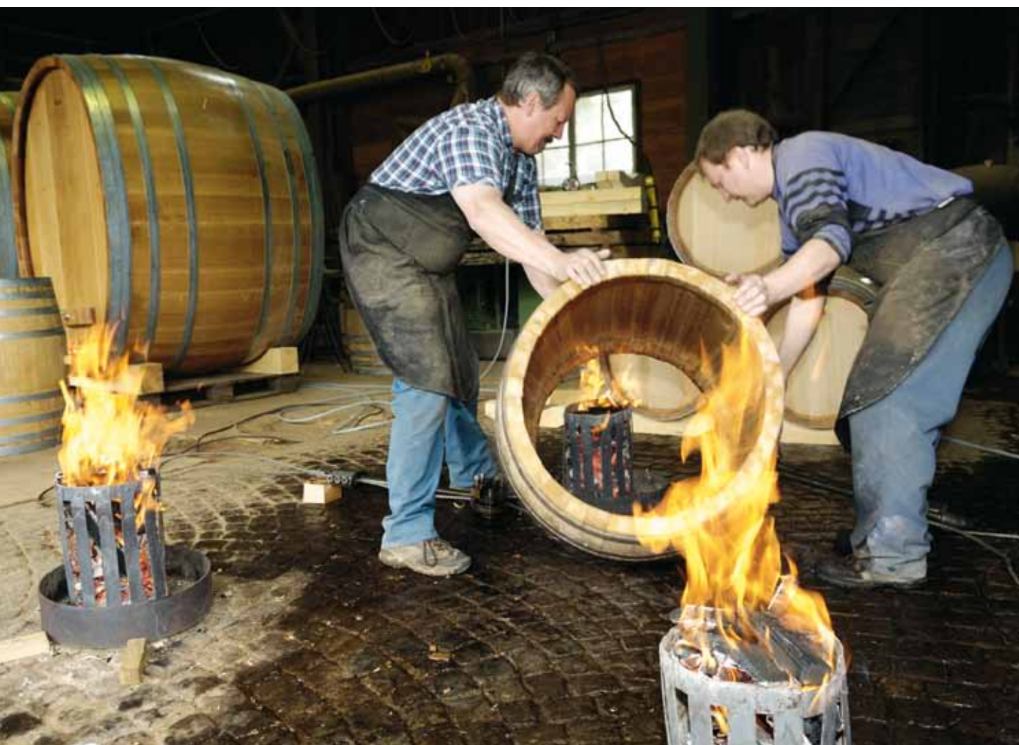
Fabrication artisanale de barriques en Suisse: les tonneliers soumettent un fût de chêne à la seconde chauffe (ou chauffe de bousinage).
