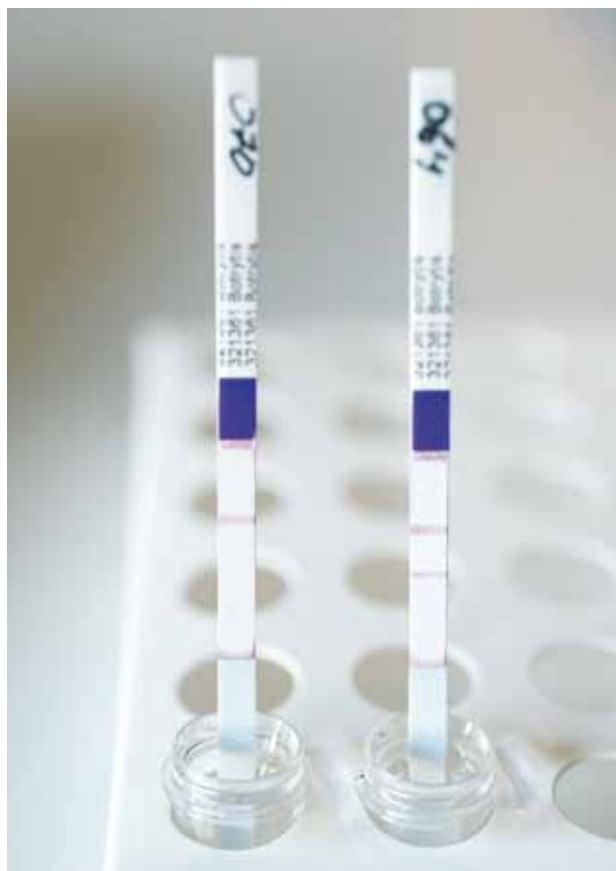
Figure 2 | Résultats du test QuickStix™ à la fin de l'analyse. À gauche, un échantillon sans pourriture (une seule ligne), à droite, un échantillon positif de la présence de Botrytis cinerea (deux lignes).
