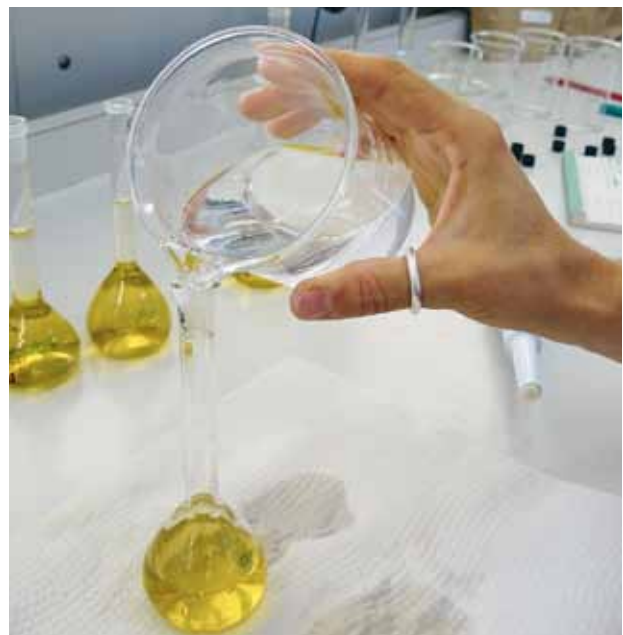
Figure 4 | Extraction de l'acide rosmarinique. Les ballons jaugés sont complétés à 50 ml avec le tampon d'extraction à 20°C.
