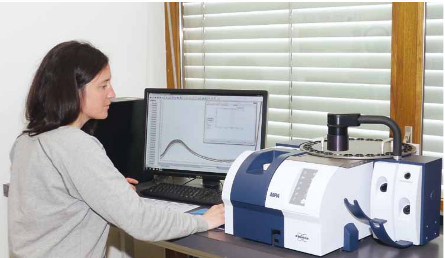
Danielle Widmer, étudiante du Master MLS Viticulture et Œnologie de Changins, avec le nouveau spectromètre proche infrarouge (Bruker MPA), qui sera utilisé à l'avenir pour l'automatisation des fermentations œnologiques et d'autres analyses du vin.
