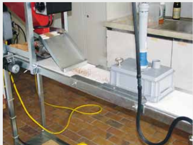
Figure 7 | Les semences de carotte sont dispersées sur le tapis roulant par le dispositif de dosage, puis passent dans la chambre de traitement où elles sont désinfectées à la vapeur aérée.
