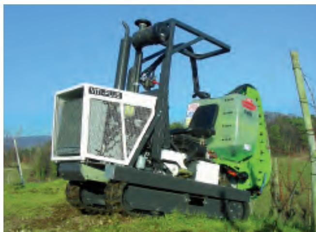
Tracteur Viti-plus équipé d'un sulfateur Fischer 561H
