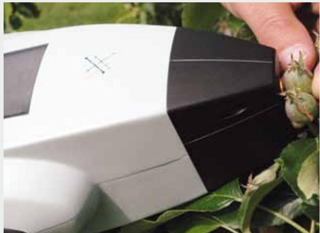
**Figure 3** | Utilisation de l'appareil NIR. Pour cette étude, les fruits ont été mesurés avec le spectromètre proche infrarouge Phazir (PZ1018, Polychromix). Cet appareil permet d'obtenir un spectre d'absorption de 930 à 1800 nm.
