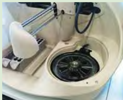
Figure 3 | Analyseur séquentiel. Dispositif de prélèvement et carrousel contenant les cuvettes de mesures.
