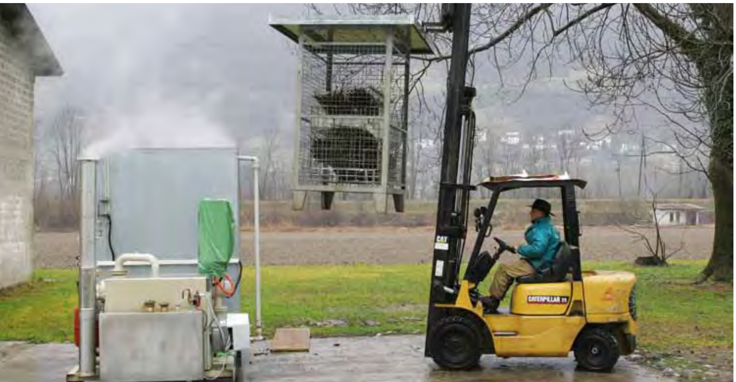
Figure 1 | Traitement du matériel à l'aide d'une unité de traitement à l'eau chaude de type RECS ( www.recs-fr.com ).
