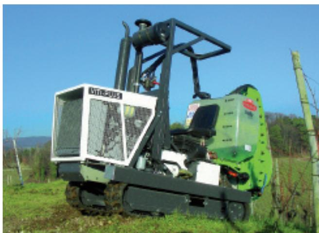
Tracteur Viti-plus équipé d'un sulfateur Fischer 561H
