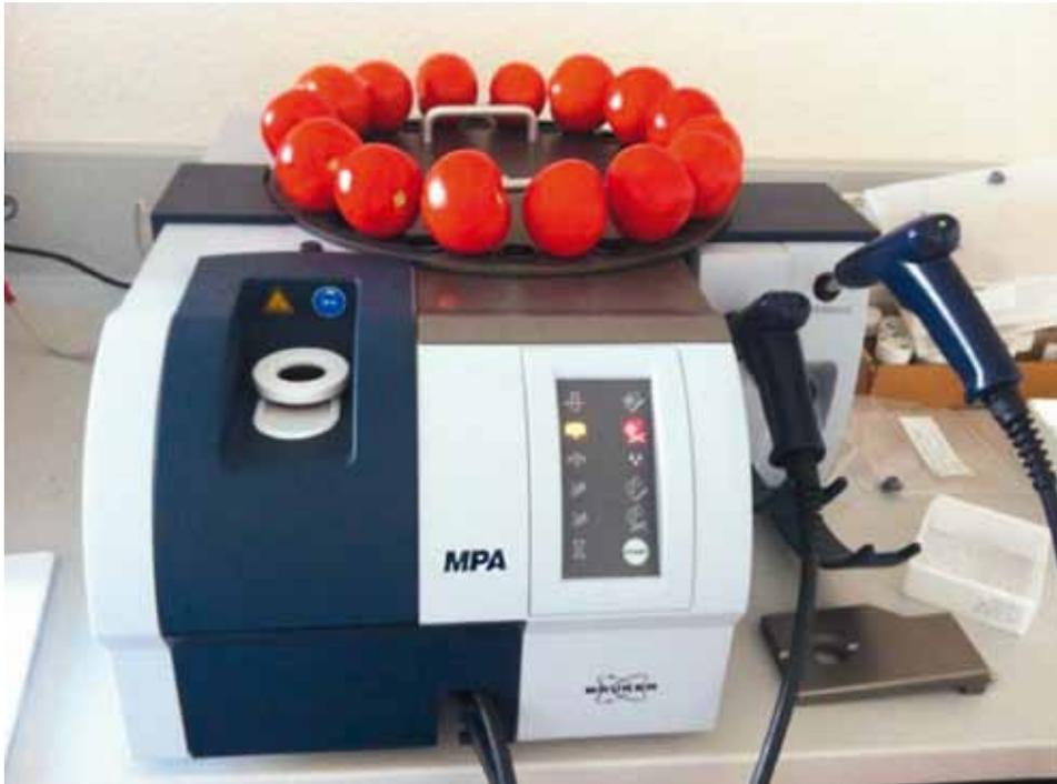
Prise de mesure au spectromètre NIR sur tomates.
