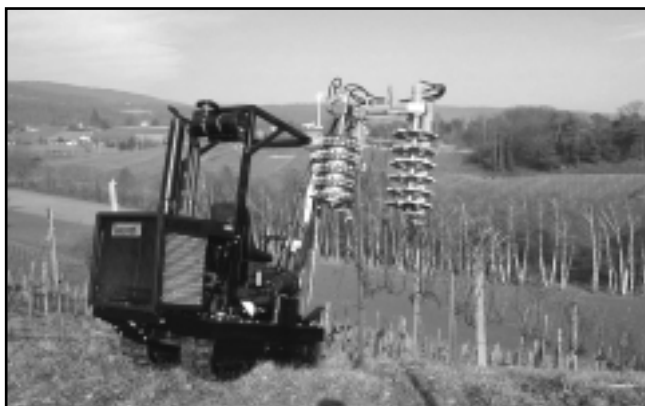
Tracteur Viti-plus équipé d'une prétailleuse Binger ou Ero
