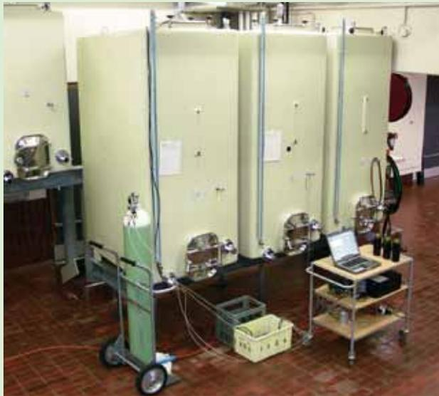
Installation de micro-oxygénation automatique avec le cylindre d'oxygène et le poste de régulation de l'apport d'oxygène.
