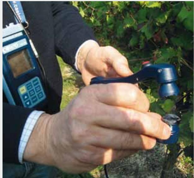
Figure 1 | Appareil Alcyone PM-3 de l'entreprise Caeleno avec sa pince de mesure prenant la pellicule d'une baie pour déterminer le *polyphenolic meter index* (PMI). (Photo: Caeleno Sàrl)
