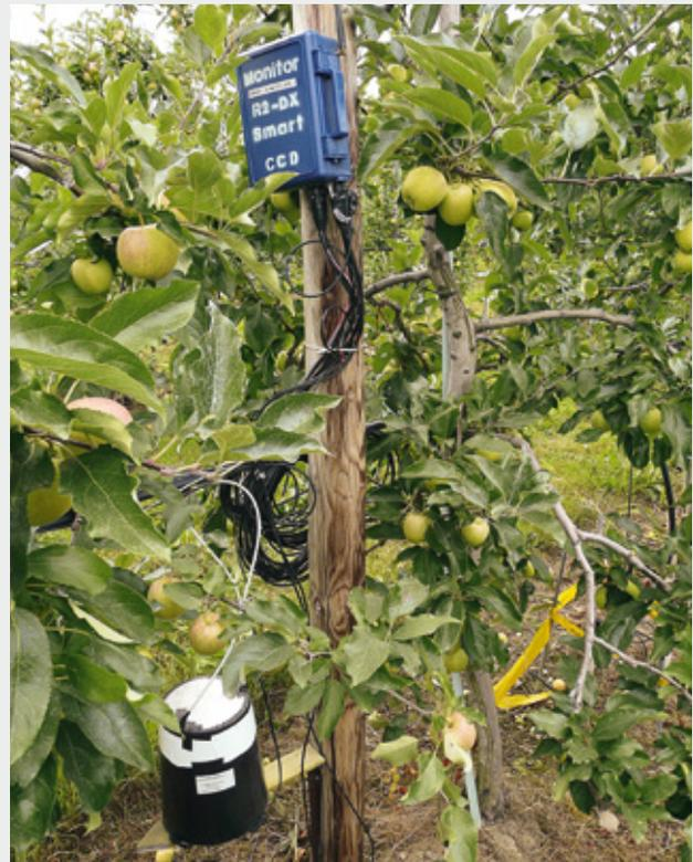
Figure 2 | La station de type R2-DX Smart est connectée à l'électrovanne qui commande l'irrigation. Le pluviomètre est isolé de la pluie et relié à un goutteur, ce qui permet d'enregistrer chaque irrigation. Les données climatiques proviennent de la station Agrométéo la plus proche.
