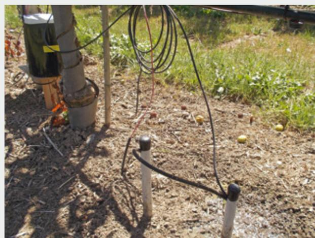
Figure 3 | Les sondes d'humidité de type Watermark® 2005S sont réparties en six groupes de deux dans une zone représentative du verger. Dans chaque groupe, la tension est mesurée à 25–30 cm et à 50–60 cm de profondeur.
