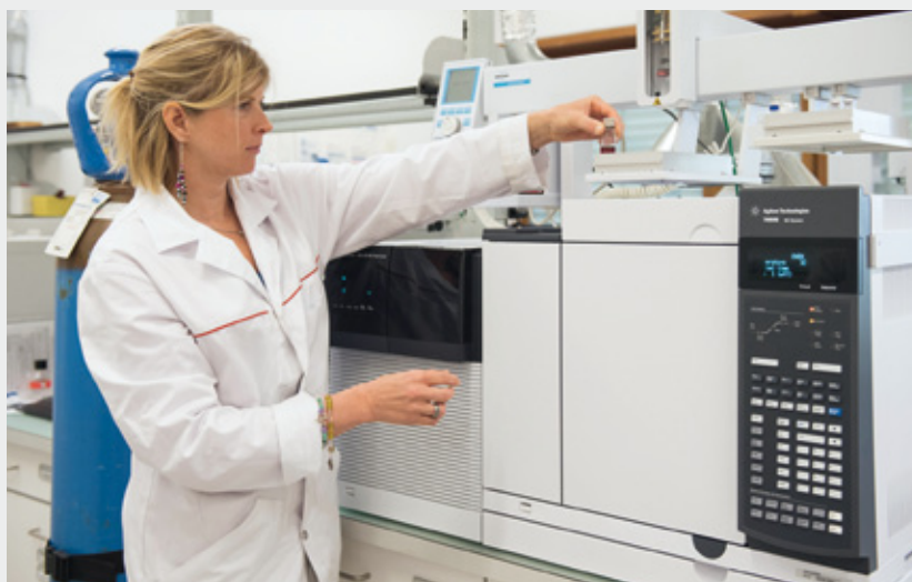
Le système de chromatographie en phase gazeuse avec spectromètre de masse triple quadrupole Agilent 7010 permet d'identifier et de quantifier les traces de composés aromatiques du vin. (Photo: Carole Parodi, Agroscope)
