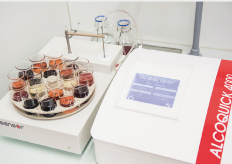
Le laboratoire de routine s'est équipé d'un appareil Unisensor Alcoquick 4000 pour l'analyse automatisée de l'alcool, de la masse volumique et de l'extrait sec. (Photo: Carole Parodi, Agroscope)
