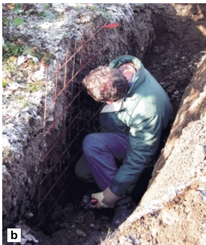
Fig. 1. Des profils de 1 m de profondeur ont été creusés perpendiculairement à la ligne de la variété Tulameen pour chaque procédé (a). Le comptage des racines a été effectué à l'aide d'un grillage avec des mailles de 15 × 15 cm (b).
