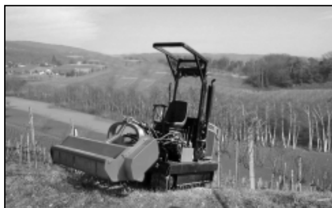
Tracteur Viti-plus équipé d'une broyeuse
