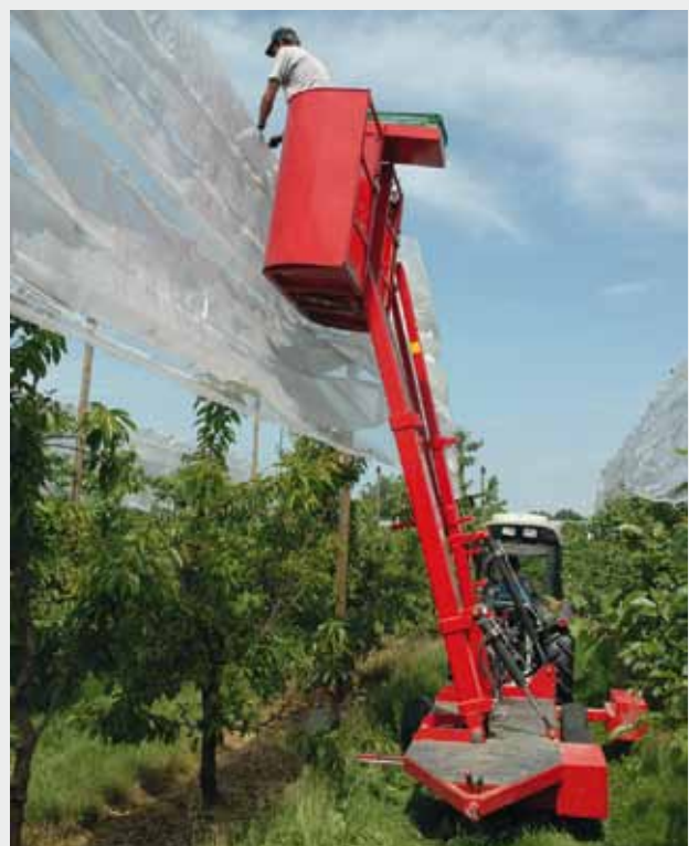
Figure 2 | Fixation des toiles de protection avec la machine Fruitwrap dans un verger de cerisiers. Cet appareil pourrait être repensé pour l'installation de toiles d'ombrage.
